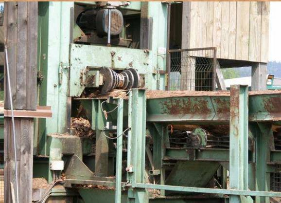
L'écorce est enlevée par une machine qui s'appelle l'« écorceuse ». Tout d'un coup, la machine s'est arrêtée à cause d'une panne. On nous a expliqué qu'une panne d'une heure coûte 1 000 €.
